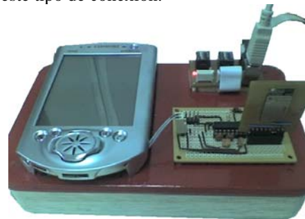
Figura 8. Implementación Hardware de nuestro modelo de conexión de la tecnología Bluetooth sobre un Dispositivo móvil
