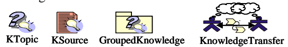
Fig. 3. Notación usada para representar los conceptos de conocimiento en diagramas de SPEM.
